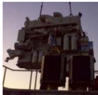
Pala O&K RH120-E repotenciada con motores Cummins QSK19
