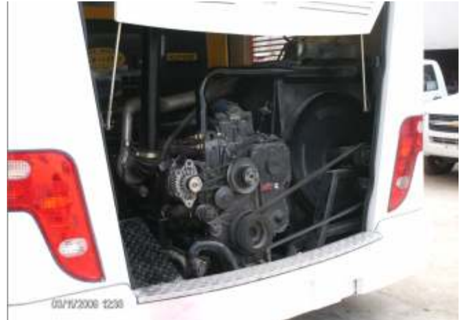
Motor cummins ISC-315 disposición trasera
